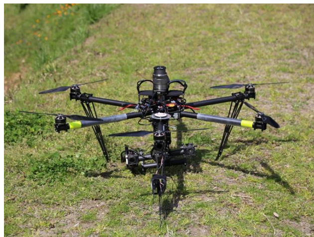
写真 - 12 上向きカメラ設置状況
